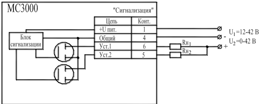
Рис. 2 Подключение к двум блокам питания
