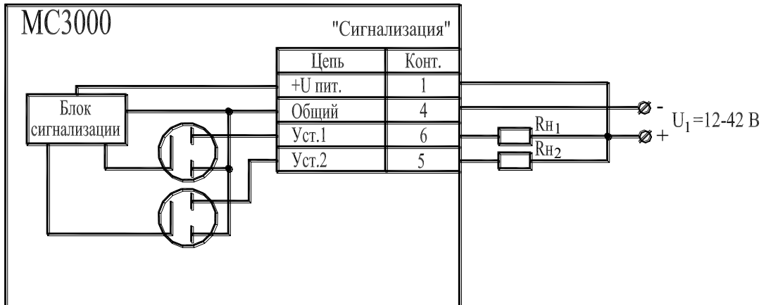
Рис. 1 Подключение к одному блоку питания
